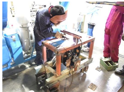
図-7 廃材利用による台上試験機製作
